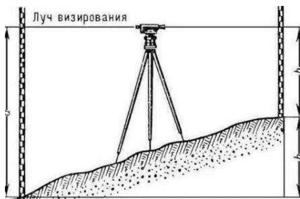
Рис. 2. Измерение крутизны склона
